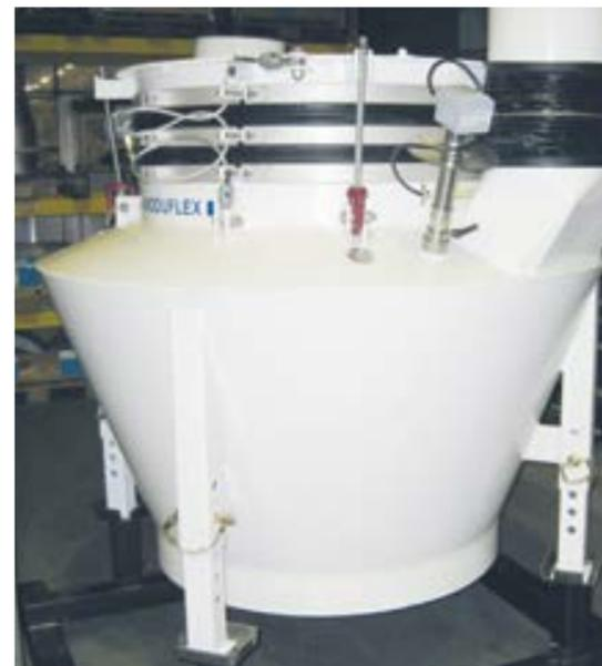
Soll die Verladegarnitur sowohl offene Schiffe, als auch geschlossene Tankschiffe beladen können, ist der Auslauf für den jeweiligen Anwendungsfall flexibel wechselbar. Es gibt einen Auslauf mit Schürze, oder Filtersystem für die offene Verladung und einen Auslauf in Kegel- oder Rechteckform für Tankschiffe. Beide Auslaufvarianten sind mit einem Schnellkupplungsverschluss ausgestattet, welches einen schnellen Wechsel des Auslauftyps ermöglicht.
