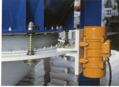
Kompakte Unwuchtmotoren versetzen den Auslauftrichter mit kleinen Amplituden in Schwingungen.
