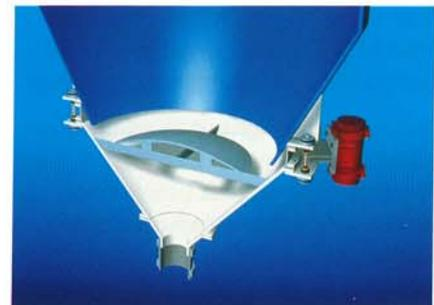
Der Deflektor überträgt die Schwingungen in die Materialsäule. Das aufgelockerte Schüttgut fließt durch den Ringspalt ab.
