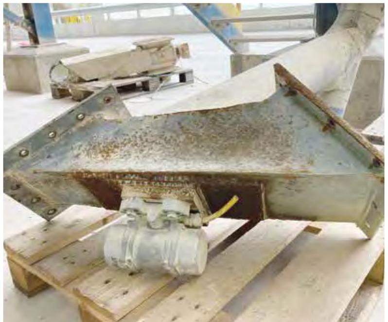
(Bild 1) Durch Hammerschläge verbeulte Schurre
